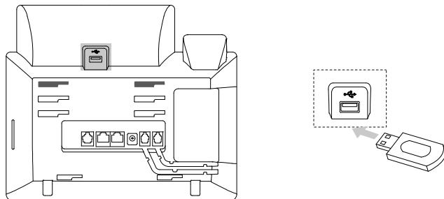
Napomena: USB priključak se također može koristiti za spajanje Bluetooth USB dongle-a BT40 ili Wi-Fi USB dongle-a WF40. Oba dodatka se prodaju zasebno. Za više informacija o načinu korištenja BT40 i WF40, pogledajte upute za ta dva dodatka.
