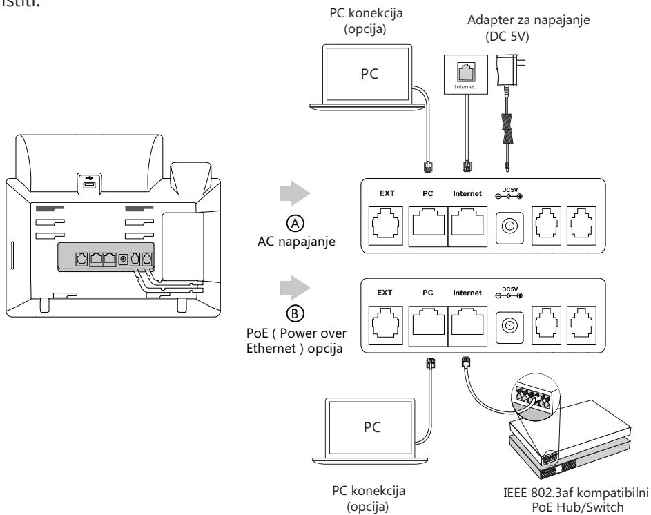
Napomena: IP telefon se mora koristiti samo uz originalni Yealink adapter za napajanje (5V/2A). Korištenje strujnih adaptera drugih proizvođača može prouzročiti štetu na telefonu. Ako spajate telefon na osobno računalo, preporučuje se korištenje mrežnog kabla koji je isporučen uz telefon. Ako se napajanje putem mreže (PoE), nije potrebno spajati adapter za napajanje. Budite sigurni da hub / switch podržava PoE.
